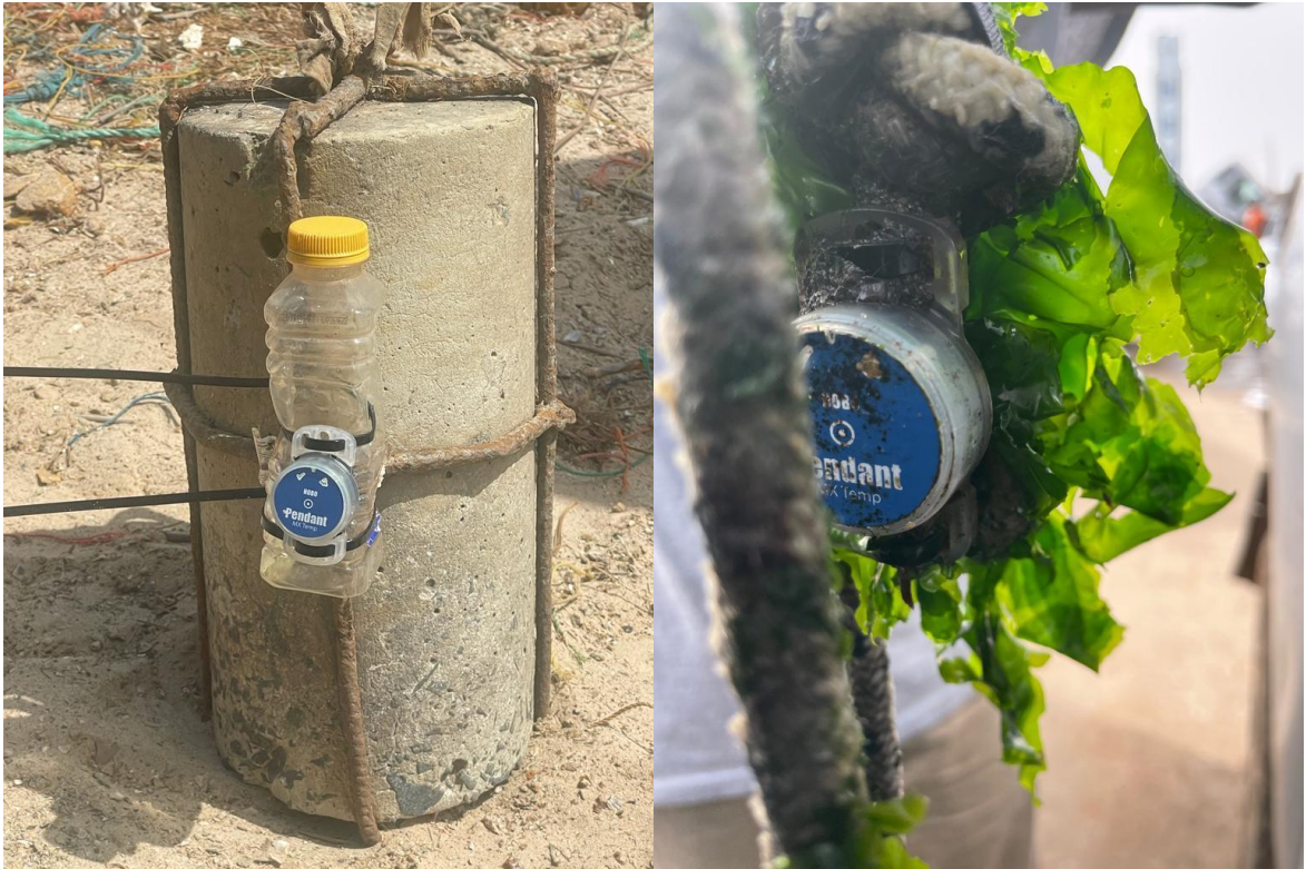
Photo 7 : Digitalisation des paramètres de collecte des données environnementaux (e.g. HOBObot pour la collecte de température de surface de la mer (C. P. B. S. Baldé ©ISRA 2025).
